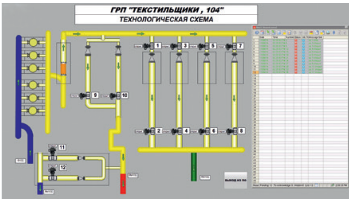
Автоматическая система дистанционного управления диско-поворотными запорными устройствами
